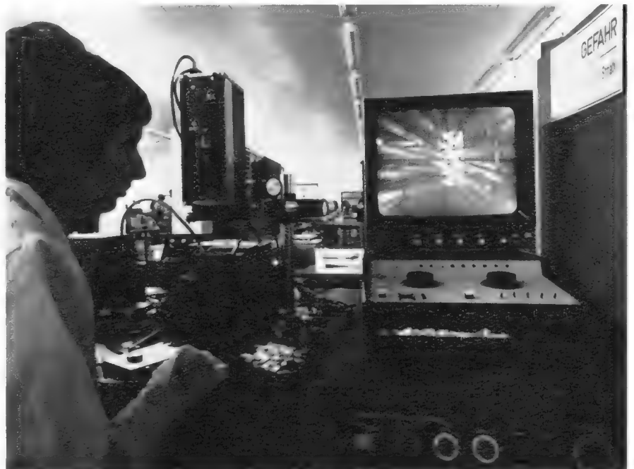
Am Abgleichplatz in der Dickschicht-Bausteinherstellung in Ulm werden die als Widerstände auf die Substrate aufgedruckten Flächen mit einem Laserstrahl so weit eingeschnitten, daß sie genau den erforderlichen Wert erhalten. Der Vorgang wird auf einem Monitor sichtbar gemacht
