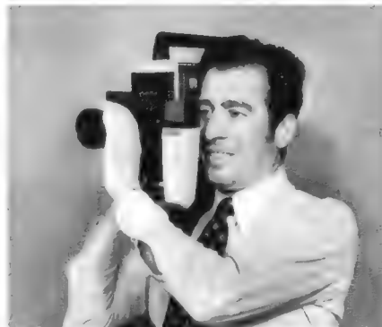
Bild 3. Diese neue Farbkamera, TK-76, ist das wichtigste Element in dem von der RCA entwickelten Reportagesystem für news gathering
