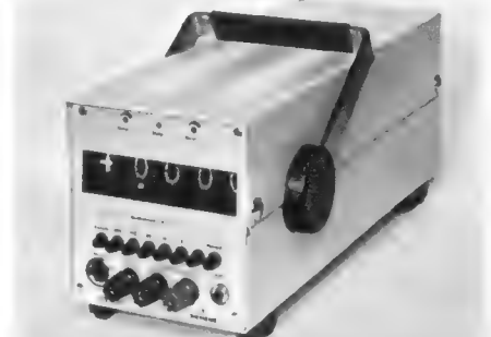
Bild 2. Digitalvoltmeter mit vierstelliger Anzeige durch Glühlicht-Ziffernröhren
